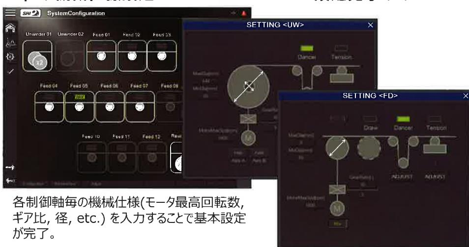
各制御軸毎の機械仕様(モータ最高回転数,
